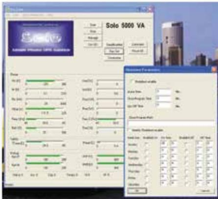
Для защиты одного компьютера (сервера, рабочего места) и соответствующих периферийных устройств, достаточно подключиться к компьютеру через RS232 или USB и установить программное обеспечение (ПО). В таком случае, через соответствующее ПО можно контролировать основные параметры работы в режиме реального времени (напряжение, ток, процент зарядки и состояние батарей), а также посмотреть статистику данных (время работы, отключение электроэнергии, сбой, средний процент зарядки и т. д.).
