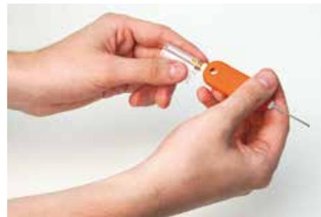
После введения маркировочных элементов в верхнюю полость трубочки производится легкое нажатие большим пальцем левой руки на конец трубочки с тем, чтобы вытащить язычок из полости трубочки.
