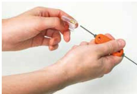
Символика, составленная из одного или более элементов, полностью набирается непосредственно на язычок, с которого она затем вводится в полость трубочки.
