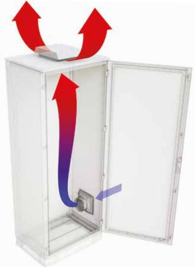
Вентиляционное оборудование, входящее в систему "RAM klima", является самым простым и бюджетным решением для организации охлаждения компонентов, расположенных внутри шкафа. При выборе данного типа охлаждения необходимо соблюдать главное условие – температура окружающей среды  $T_a$  должна быть ниже, чем температура внутри шкафа  $T_i$ , при этом  $T_i - T_a \geq 5 \text{ }^\circ\text{C}$ .
