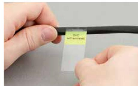
Закрепите маркировочный элемент на поверхности перпендикулярно поверхности
