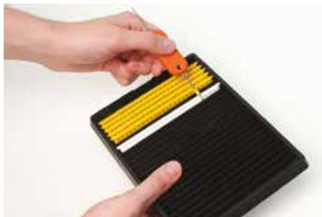
Вставьте планки с символами в поддон для планок. Код 118. После того как планки с нужными символами вставлены, можно извлекать маркировочные элементы с помощью язычка (коды 119/15U или 119/30U), в зависимости от длины таблички.
