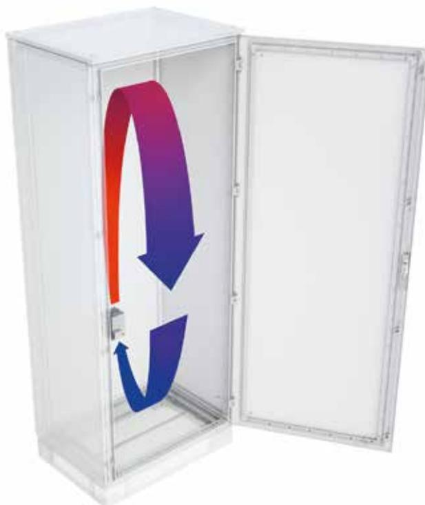
Обогреватели, входящие в систему контроля микроклимата "RAM klima", обеспечивают защиту оборудования от переохлаждения и предотвращают достижение температуры точки росы, при которой происходит конденсация влаги на токоведущих элементах, что приводит к образованию коррозии и возможности короткого замыкания.
