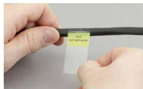
Закрепить маркировочный элемент на поверхности
